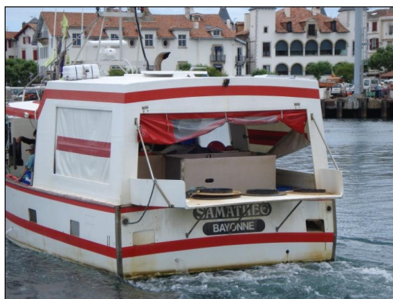
Figure 76 : pont couvert sur le SAMATHEO. Source : CNPMEM.
