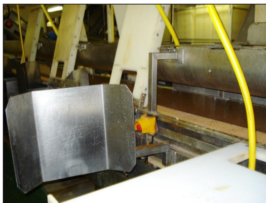
Figure 77 : support de dos sur les postes de tri du poisson. Source : CNPMEM.
