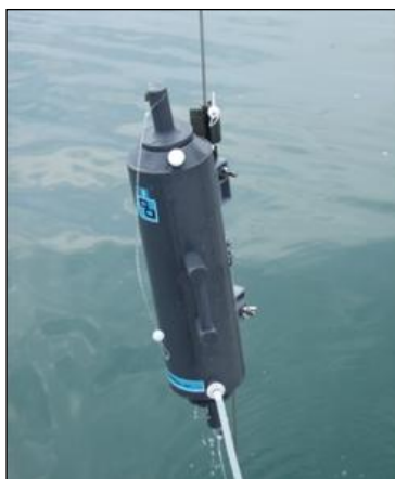
Figure 63 : bouteille de type Niskin utilisée pour les prélèvements d'eau. Source : site Internet Ifremer.
