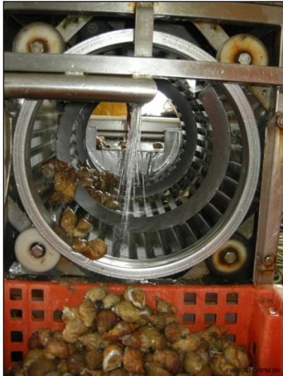
Figure 5 : photo d'une grille de tri pour destinée aux bulots. Source : CRPMEM Basse-Normandie.
