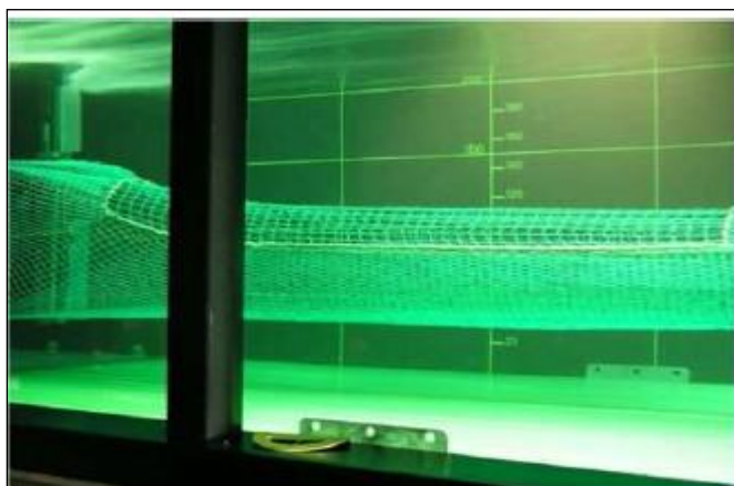
Figure 13 : essais en bassin de la fenêtre à mailles carrées à Boulogne-sur-Mer. Source : CRPMEM Nord Pas-de-Calais/Picardie.
