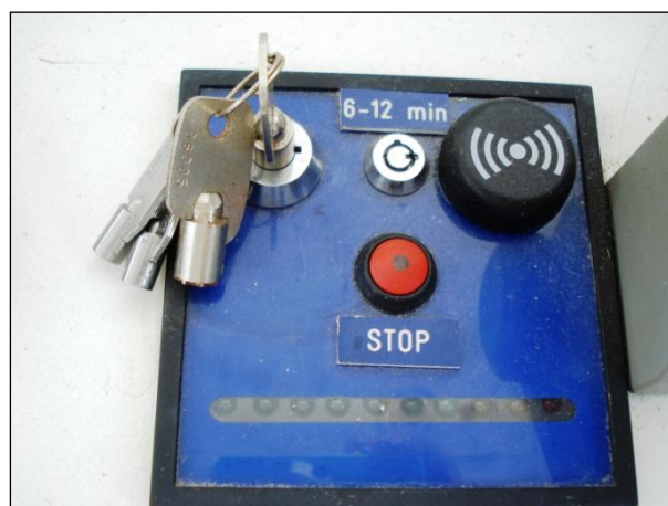
Figure 72 : alarme de vigilance homme de quart mise en place sur le P'TIT IDEFIX . Source : CNPMM.
