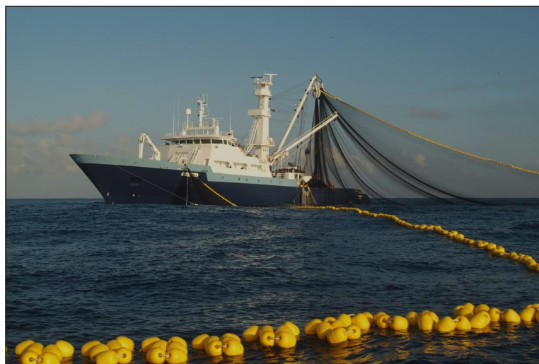
Figure 37 : thonier senneur congélateur lors d'une opération de pêche. Source : CNPMM.
