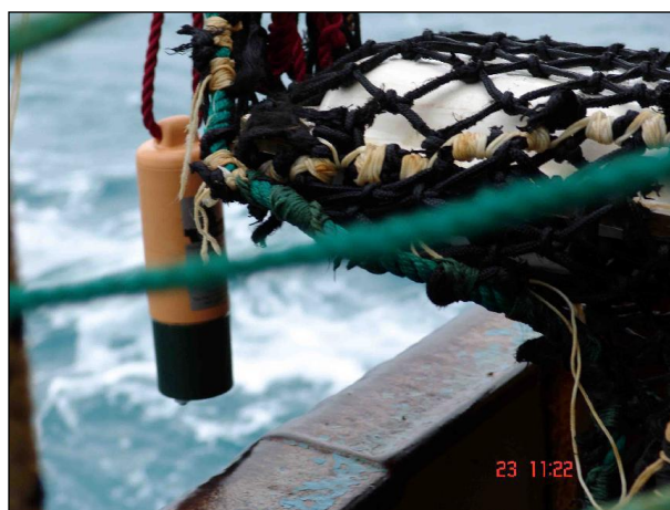
Figure 36 : Répulsif acoustique en place sur un chalut pélagique. Source : Anonyme 3 , 2007.
