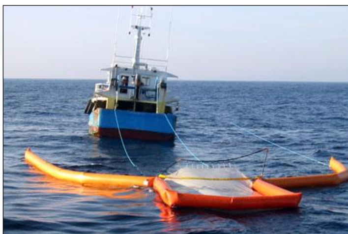
Figure 65 : utilisation du chalut Thomsea. Source : site Internet de la société Thomsea.
