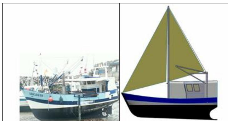
Figure 69 : Simulation de la mise en place de voiles sur le navire COMMANDANT COUSTEAU . Source : Site Internet Avel Vor Technologie.
